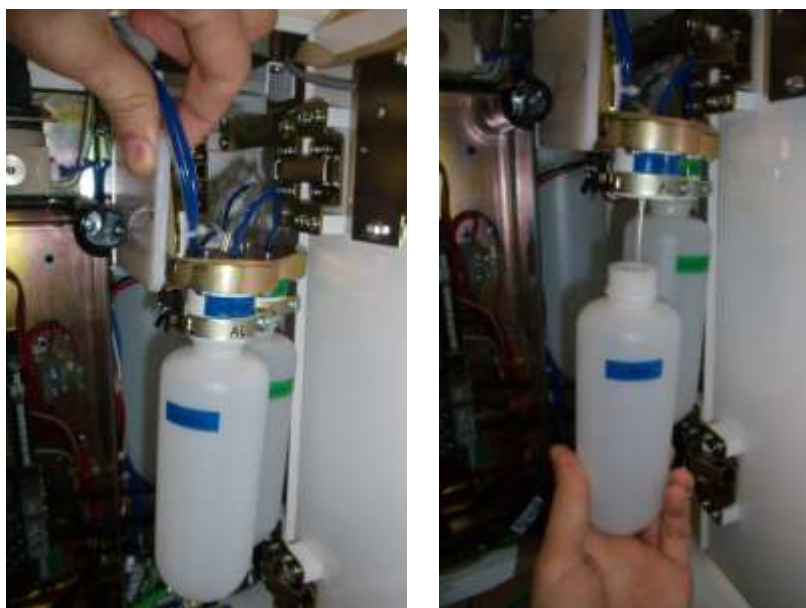
Рис. 1 Резервуар с раствором ALPRON
