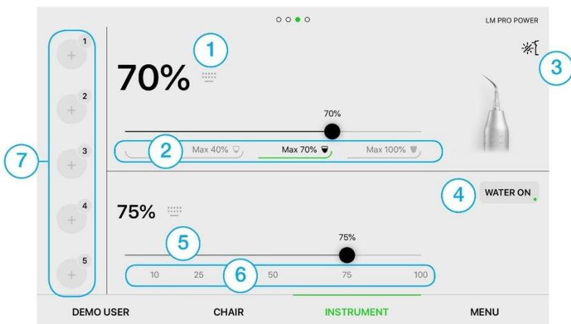
1. Настройка максимальной мощности скалера. Данная функция позволяет установить необходимое значение максимальной мощности инструмента.
